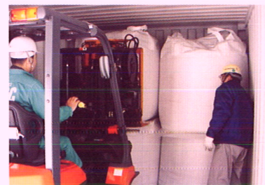
③コンテナ内でフレコンを積み込みします。
