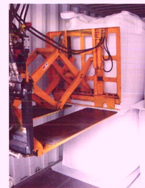
①フレコン積みされた荷物をデバンニングします。
