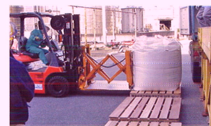
③シートリテーナー機構により、シートを引き抜きながらフレコンをパレタイズします。シートと一緒にパレタイズすることも可能です。
